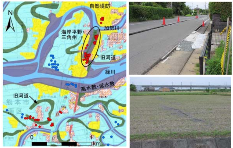
図-4 熊本地震における液状化事例 (熊本市富合町杉島 加瀬川旧河道)
