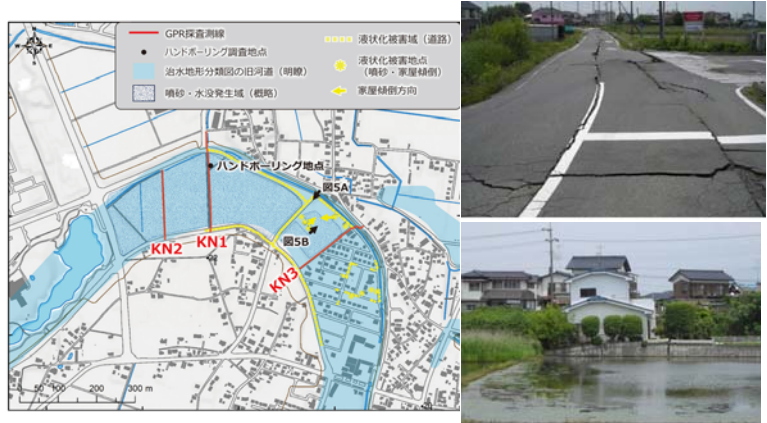
図-3 東北地方太平洋沖地震における液状化事例 (茨城県下妻市 鬼怒川旧河道)
