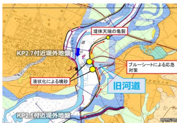
図-7 北海道胆振東部地震における液状化事例（むかわ町 鶴川）
