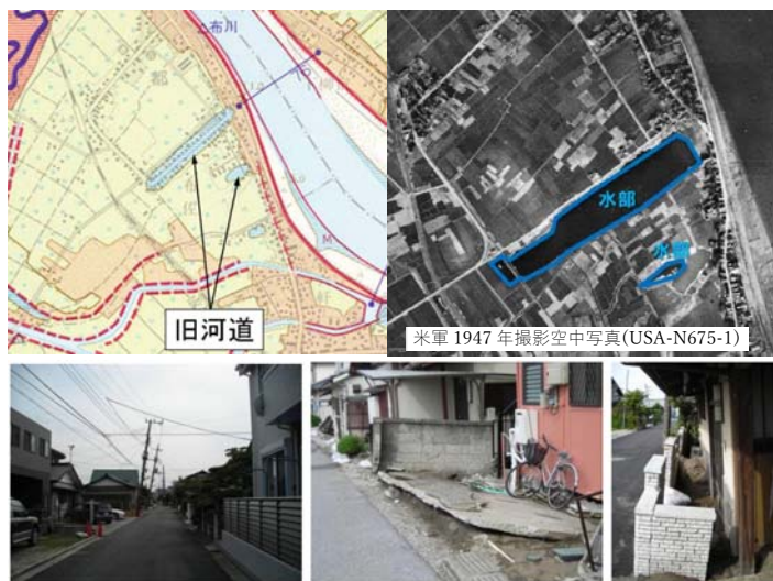
図-1 東北地方太平洋沖地震における液状化事例 (千葉県我孫子市布佐 利根川旧河道)
