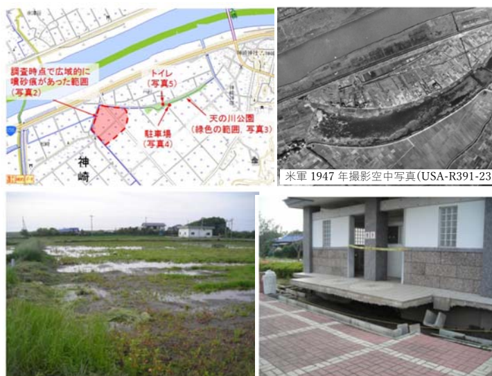
図-2 東北地方太平洋沖地震における液状化事例 (千葉県神崎町 利根川旧河道)
