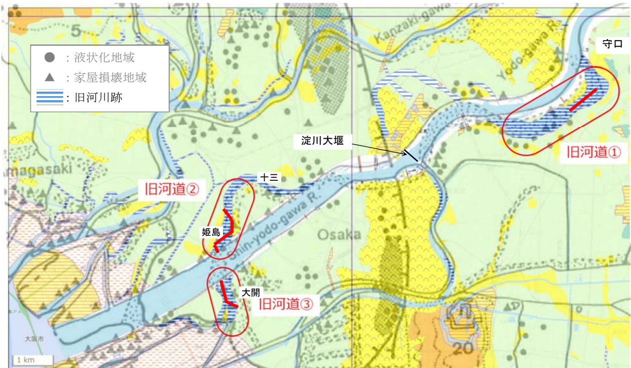
図-10 兵庫県南部地震における液状化被害分布と地水分類図
